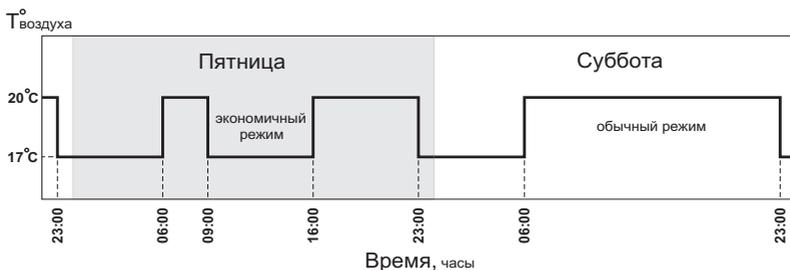
**Рис.7 График температуры воздуха в помещении для Режим 3.**
