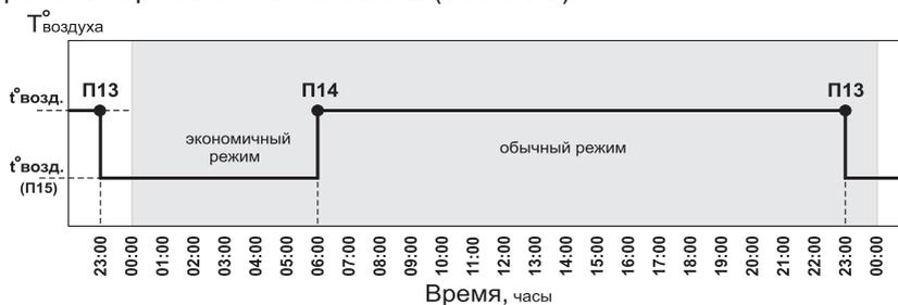
**Рис.6 График температуры воздуха в помещении для Режим 2.**
