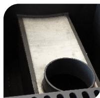
**Лёгкий пар.** Верхняя крышка коллектора, несущая наибольшую термическую нагрузку изготовлена из нержавеющей стали толщиной 4мм, с содержанием хрома 17% и имеет вогнутую форму. При эксплуатации она раскаляется до свечения, создавая поверхность для получения высокотемпературного лёгкого пара.
