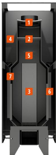
**Жаростойкая нержавеющая сталь 08Х17Т толщиной 4 мм с содержанием хрома 17% и титана.**
