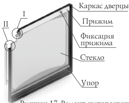
Рисунок 17. Ремонт светопрозрачного экрана двери модели «Витра»
